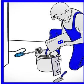
جزء **A مایع** را در ظرف تمیزی ریخته و سپس جزء **B پودر** را به آرامی و در چند مرحله اضافه می کنیم و با یک جسم سخت مانند یک تکه چوب ویا میکسریبا سرعت کم هم میزنیم. مخلوط کردن را تا جایی ادامه می دهیم که ترکیبی همگن و بدون دون دون به دست آید (تقریباً 3-5 دقیقه) طول میکشد
